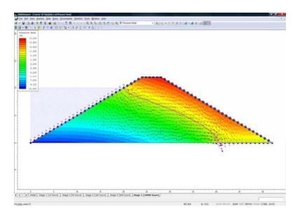
Usted puede ver que el flujo del agua hacia el pie de drenaje en la parte inferior derecha. Si usted hace clic en los tabuladores de la etapa nuevamente, usted verá la progresión de flujo a través de la presa con el tiempo.
