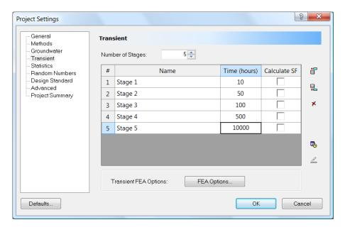
No coloque check en las casillas para Calcular el SF ("Calculate SF") (factor de seguridad). En este tutorial, nosotros sólo observaremos al modelado de agua subterránea. Un tutorial subsecuente combinará
