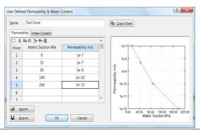
Usted puede ver que la permeabilidad será de 1e-7 m/s, hasta que la succión exceda 15 kPa, tiempo en el que la permeabilidad descenderá con la succión en aumento.
