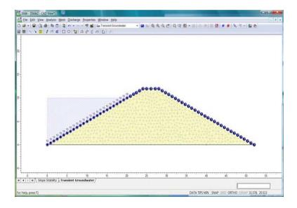
Ahora para el Tipo BC, elija Presión Cero ("Zero Pressure"). Haga clic en la sección horizontal en la parte derecha inferior del modelo (al pie del drenaje). Haga clic en Aplicar ("Apply"). Haga clic en Cerrar ("Close") y el modelo debe lucir como esto:
