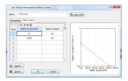
Usted puede observar que en una succión matricial 0, la retención del agua es 0.4. Si asumimos que el material está 100% saturado en esta presión, entonces esto sugiere una porosidad de 0.4. Si la succión matricial incrementa, la retención del agua disminuirá, lo que sugiere un descenso en saturación.
