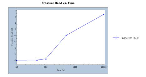
Usted puede observar que la presión no alcanzó el punto hasta 100 horas después aproximadamente, después de alcanzado el nivel de agua, y eso después de 100 horas, la presión de cabeza alcanzó a su valor de estado estacionario de ~2.4 m en 10,000 horas.
