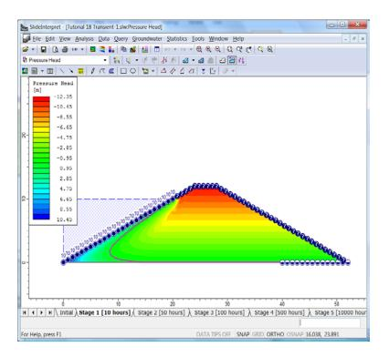
Usted podrá ver cómo el incremento rápido en el nivel del agua en el margen izquierdo ha inducido las presiones de poros altas a lo largo del flanco izquierdo, pero que el agua no ha fluido aún a través de la presa para incrementar las presiones en otro sitio.
